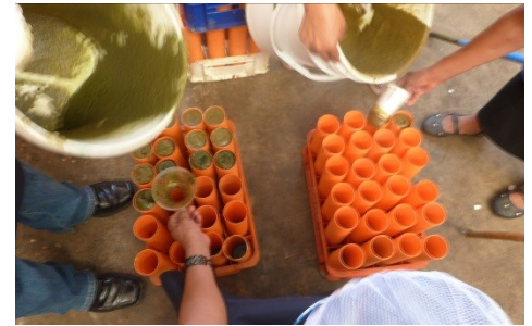
Proceso de vaciado de la mezcla
