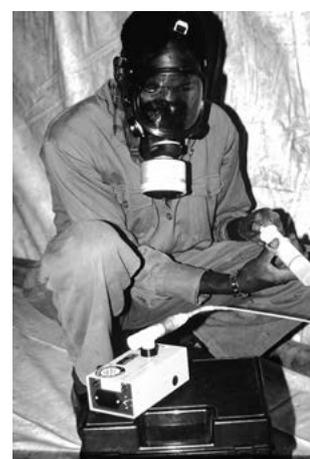
**Figure 5.33: Compteur électronique utilisé pour estimer la concentration de phosphine**
