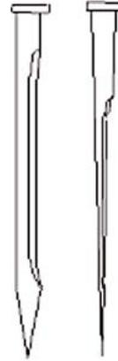
**Figure 5.1: Sondes d'échantillonnage - sonde cylindrique (à gauche), sonde conique (à droite)**
