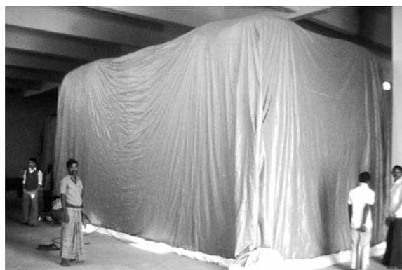
**Figure 5.28: Une pile de sac placée sous une bâche pour la fumigation**
