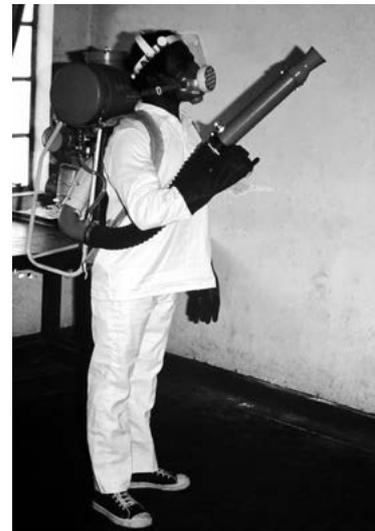
**Figure 5.30: Pulvérisateur motorisé en cours d'utilisation**
