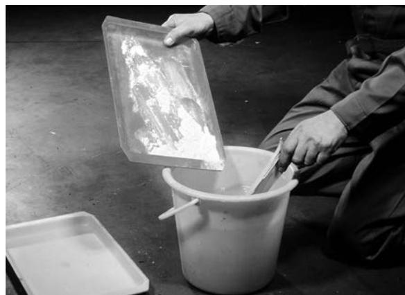
**Figure 5.40: Le mélange des résidus de phosphide avec de l'eau pour les désactiver**
