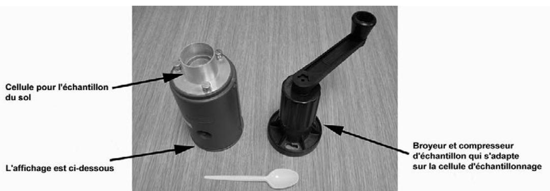
**Figure 5.24: Un humidimètre - humidimètre de résistance**
