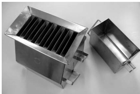
**Figure 5.4: 'Diviseur à boîtes' pour la séparation des échantillons d'une manière représentative**
