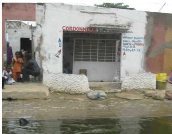
Photos 24 et 25 : boutique avec muret de protection à l'entrée et construction avec un accès rehaussé
